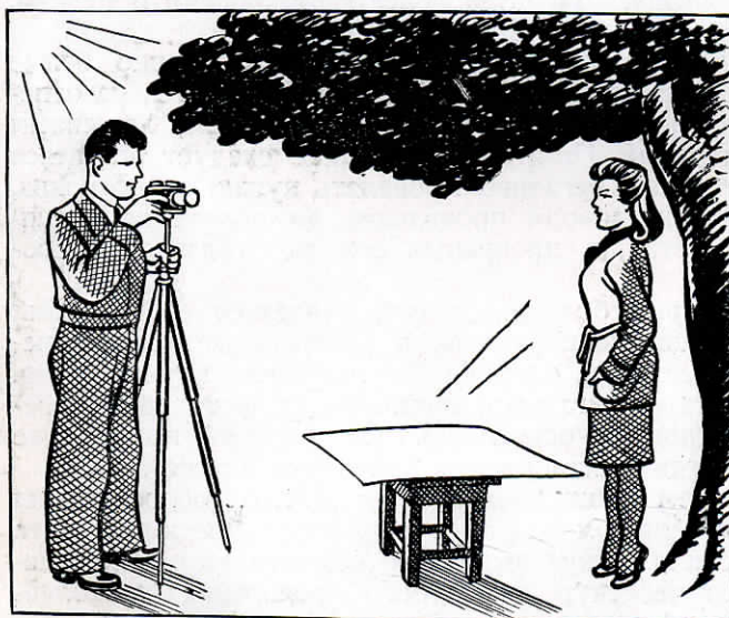
Рис. 101. Подсветка передним светом посредством отражающего экрана
