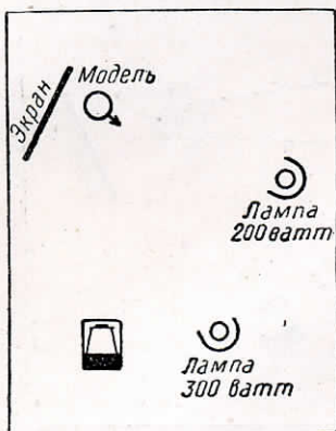
Рис. 106. Схема портретной съемки с освещением двумя полуваатными лампами
