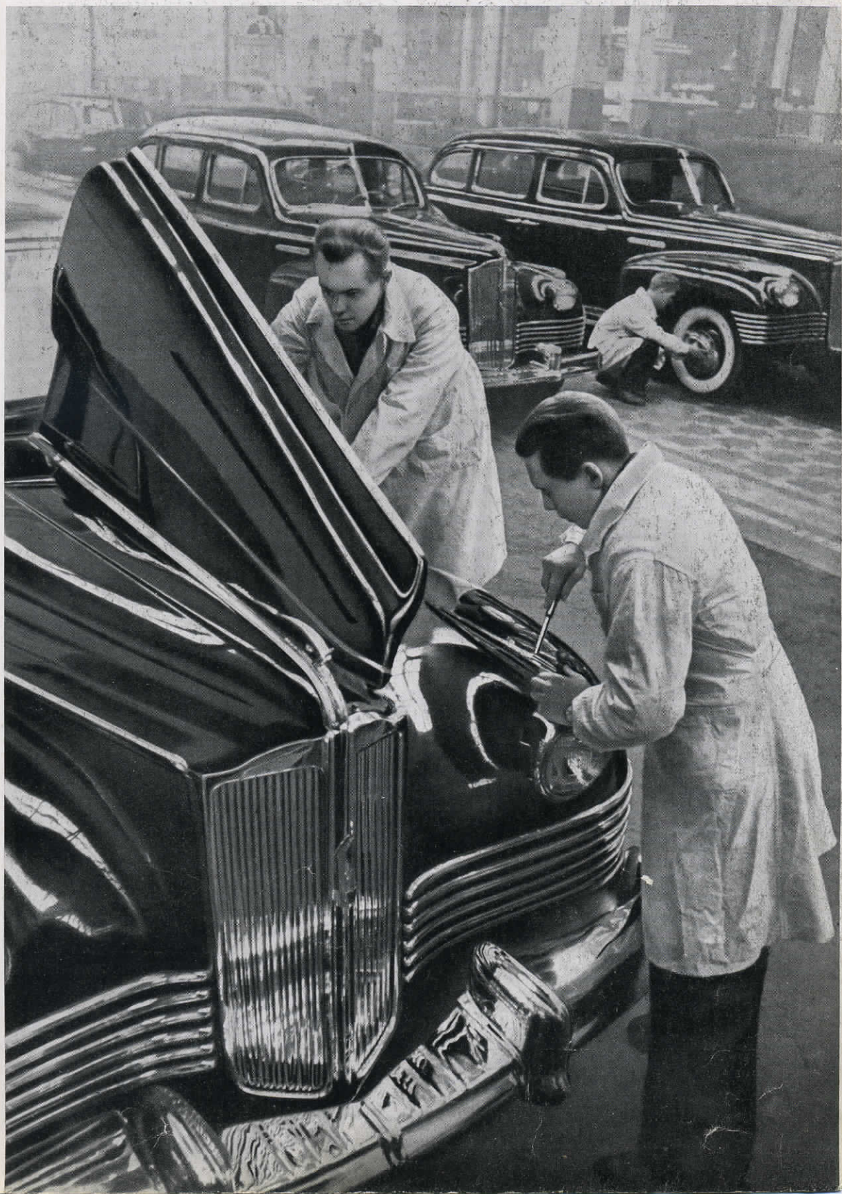
Фото 61.—М. Трахман.—В цехе сборки легковых автомашин «ЗИС-110» (к уроку 21)
