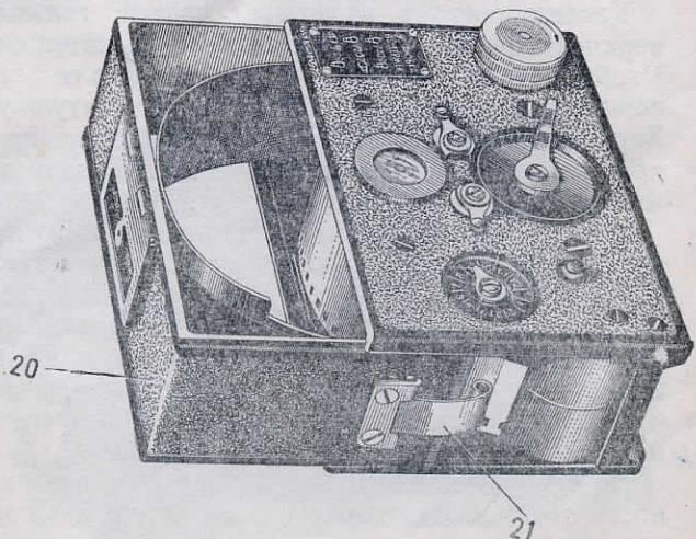
Рис. 4. Фотокамера ФТ-2. Вид на боковые стенки.
