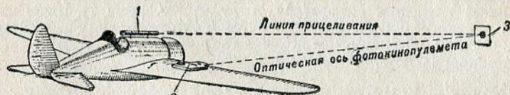
Рис. 74. Схема пристрелки фотокинопулемета, установленного на самолете
