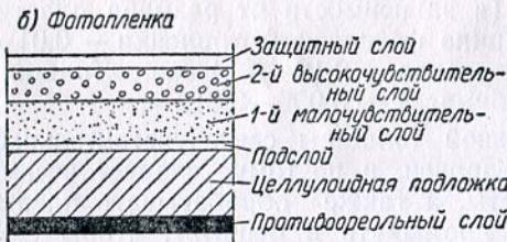
Рис. 8. Поперечный разрез черно-белых фотоматериалов
