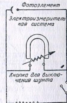
Рис. 54. Принципиальная схема фотоэлектрического экспонометра
