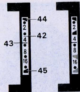
Если стрелка перекрыта указателем 44 в начале шкалы диафрагм (положение «Света мало»), значит для проведения съемки недостаточно освещения. Спусковая кнопка в этом случае заблокирована (затвор не срабатывает). Кнопка может быть заблокированной и при положении стрелки вблизи указателя. Для съемки необходимо увеличивать выдержку, пока стрелка не отклонится до следующего значения диафрагмы.
