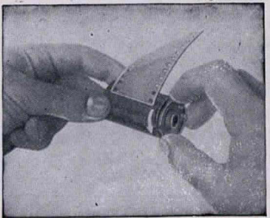
Рис. 11. Закрывание кассеты.
