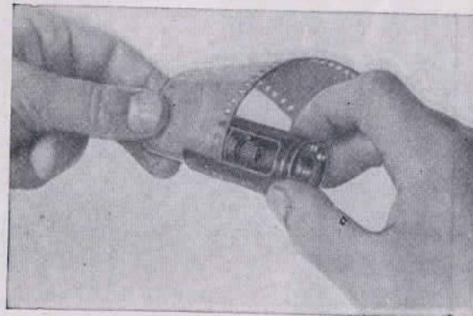
Рис. 9. Вкладывание катушки в цилиндр.
