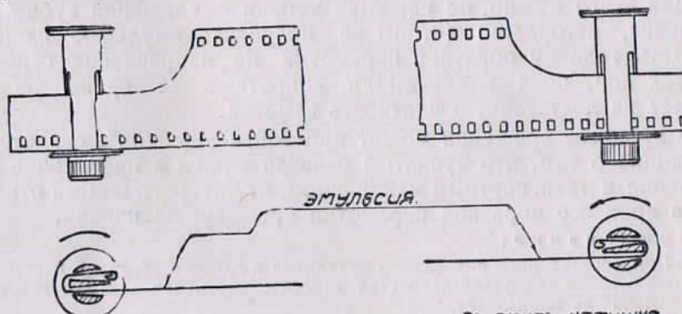
Рис. 7. Схема заправки пленки.
