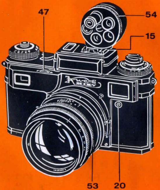
однако для уменьшения нагрузки на механизм фотоаппарата вращать нужно не диск 47, а кольцо расстояний 53 объектива.
