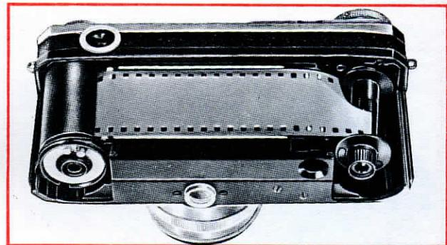
Рис. 11. Аппарат, заряженный кассетой и катушкой
