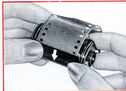
Рис. 10. Закрывание кассеты крышкой
