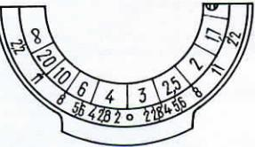
Рис. 19. Установка объектива на дистанцию 4 м
