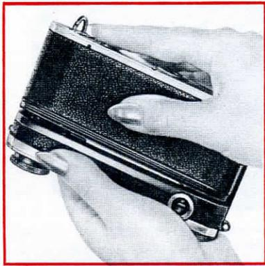
Рис. 7. Снятие задней стенки
