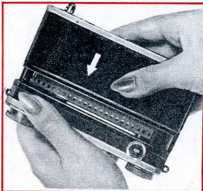
Рис. 12. Закрывание задней стенки
