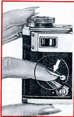
Рис. 22. Взвод рычага автоспуска
