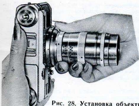
Рис. 28. Установка объектива  $F=13,5$  см
