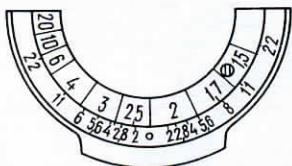
Рис. 18. Установка объектива на дистанцию 2,5 м
