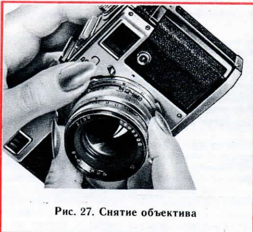
Рис. 27. Снятие объектива
