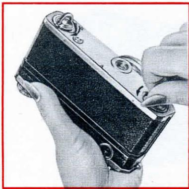
Рис. 6. Открывание замков на задней стенке
