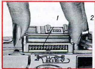
Рис. 25. Открывание крышки фотоэлемента
