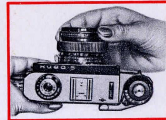
Рис. 13. Диафрагмирование объектива
