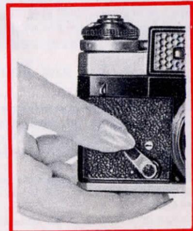
Рис. 17. Взвод рычага автоспуска
