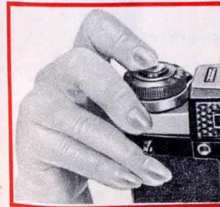
Рис. 16. Спуск затвора
