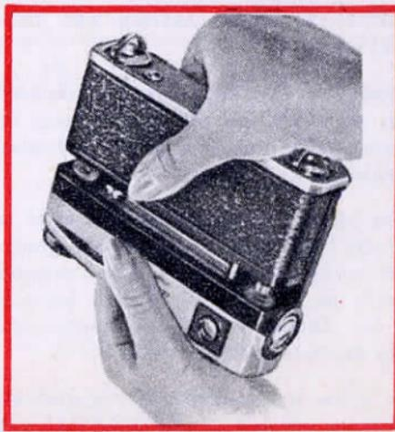
Рис. 5. Снятие задней стенки
