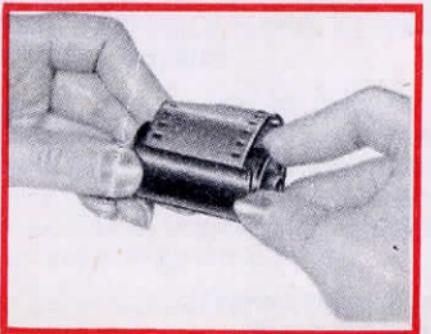
Рис. 9. Закрывание кассеты
