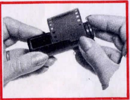
Рис. 8. Надевание наружного цилиндра на внутренний
