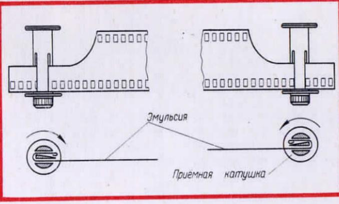
Рис. 7. Схема заправки пленки
