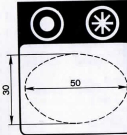
Экспонометрическое устройство обеспечивает измерение в диапазоне яркостей от 1,6 до  $13\,000$  кд/м<sup>2</sup>, при этом учитываются величины светочувствительности применяемой пленки (от 8 до 1000 ед. ГОСТ или от 10 до 31 ед. DIN), выдержки (от 1/1000 до 8 с) и диафрагмы (от 1,4 до 32).
