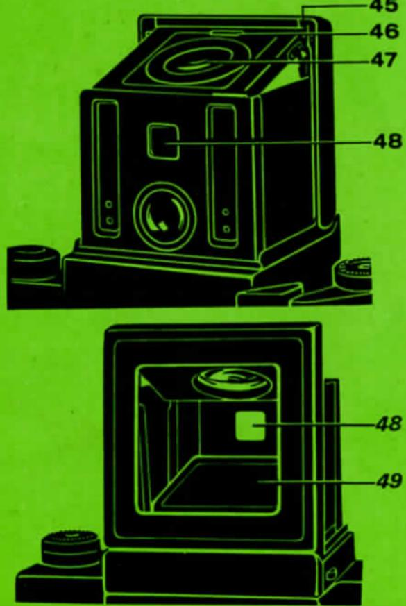
стенке видоискателя до защелкивания ее фиксатором, затем сложите боковые стенки (сначала левую, потом правую), потом заднюю стенку и, придерживая ее, возвратите переднюю стенку в исходное положение.
