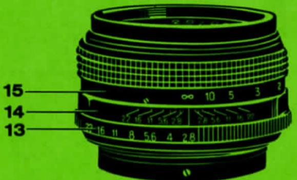
Диафрагму устанавливайте поворотом кольца 13 до совмещения выбранного значения с индексом на неподвижном кольце. На всех значениях диафрагм шкала фиксируется.
