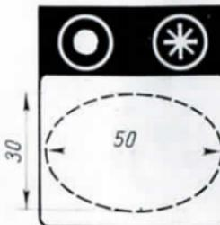
те всех влияющих на величину экспозиции факторов. Поле измерения устройства находится в центральной части поля зрения визира и имеет овальную форму (см. рисунок).
