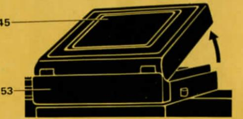
ца со шкалой 14. Наводка на резкость по матовому стеклу осуществляется только при взвешенном затворе, когда зеркало находится в рабочем положении и диафрагма полностью открыта.
