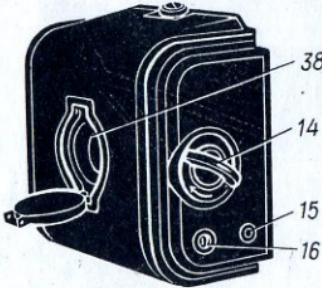
Поворотом на 90° поднимите одну из половин рукоятки 14 и, вращая эту рукоятку против стрелки, установите цифру «1» в окне 16 счетчика кадров. Вставьте транспортирующий механизм 31 в корпус кассеты до упора, слегка поворачивая рукоятку 14 по стрелке. Установите рукоятку 14 в исходное положение. Поверните рукоятку 17 по часовой стрелке до упора и установите ее в исходное положение. Вставьте задвижку 18 до упора.
