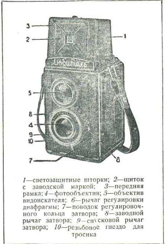
1—светозащитные шторки; 2—щиток с заводской маркой; 3—передняя рамка; 4—фотообъектив; 5—объектив видоискателя; 6—рычаг регулировки диафрагмы; 7—проводок регулировочного кольца затвора; 8— заводной рычаг затвора; 9—спусковой рычаг затвора; 10—резьбовое гнездо для тросика
