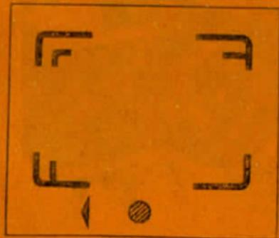
6.1.4. Наблюдая в видоискатель, слегка нажмите на спусковую кнопку до начала срабатывания затвора и проконтролируйте условия освещенности объекта съемки.
