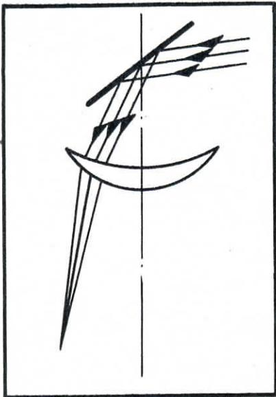
Рис. 5. Применение Волластоном менисковой линзы в камере-обскуре
