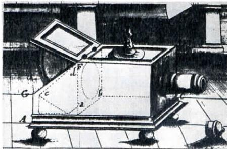
Рис. 4. Камера-обскура с зеркалом Зана
