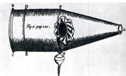
Рис. 3. Портативная камера-обскура Хуком
