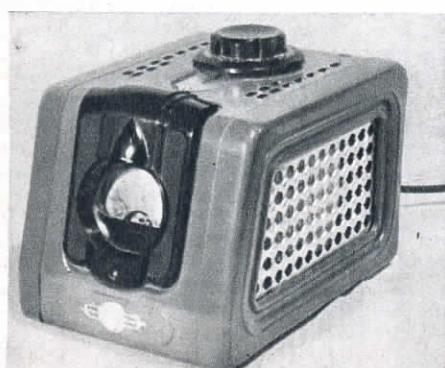
Автотрансформатор ЛАТР-2 позволяет плавно изменять напряжение на выходе, в пределах от 0 до 250 в, что дает возможность подводить к питаемому от него источнику света желаемое напряжение. Автотрансформатор можно нагружать током до 2,5 а.
