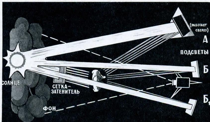
Рис. 2. Схема расположения подсветов при контролевом освещении (вид сверху)
