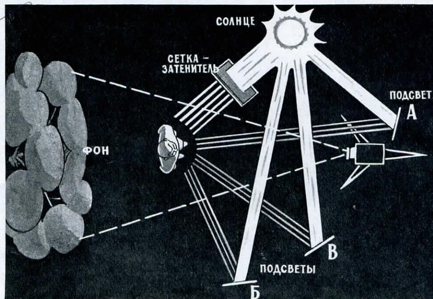
Рис. 1. Схема расположения подсветов при боковом освещении
