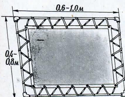
Рис. 4. Складной отражатель
