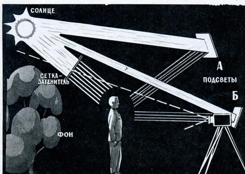
Рис. 3. Схема расположения подсветов при контролевом освещении (вид сбоку)
