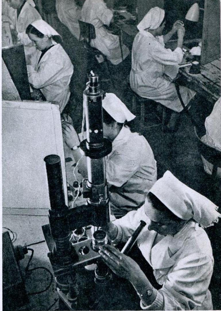
Проверка блока объектива
