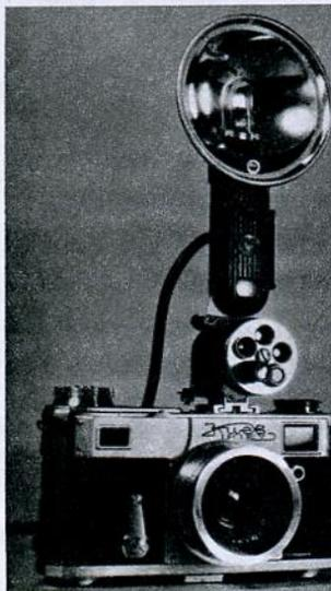
Мною изготовлено приспособление, которое позволяет крепить рефлектор лампы «Луч-57» на универсальном видоискателе при съемке сменной оптикой.
