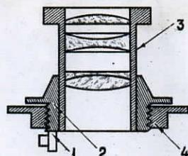
Рис. 2. Правильное положение кулачка: 1 — кулачок дальномера, 2 — подвижный тубус червячной оправы, 3 — тубус объектива, 4 — неподвижная часть червячной оправы
