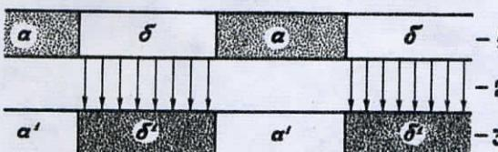
Рис. 1. Схема одноступенчатого фотографического процесса: 1 — негативный фотослой [а — экспонированные участки негатива, б — неэкспонированные участки негатива], 2 — проявляющая паста, 3 — приемный слой позитива [а' — непроявленные участки позитива, б' — проявленные участки позитива]
