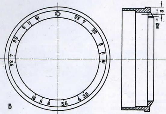
Кольцо вытасчивают из дюралюминия, но можно изготовить его на оправке подходящего диаметра из проволоки диаметром 3—3,5 мм.
