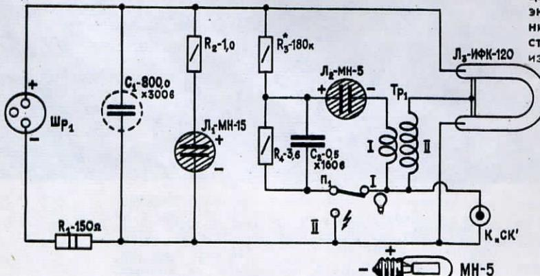
Рис. 1. Измененная схема импульсной лампы ЭВ-1
