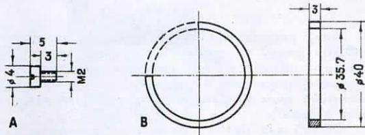
ний (оправа крепится тремя винтами, расположенным под углом  $120^\circ$ ), высверливают в ней отверстие и делают резьбу, как указано на рисунке (б).
