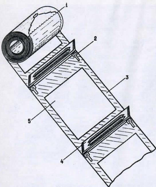
Рис. 2. Позитивная лента фотокомплекта «Момент»: 1 — кадровая надсечка, 2 — фиксаторная стрелка, 3 — прокладочная бумага, 4 — капсула с проявляюще-фиксирующей пастой, 5 — кадровое окно позитива
