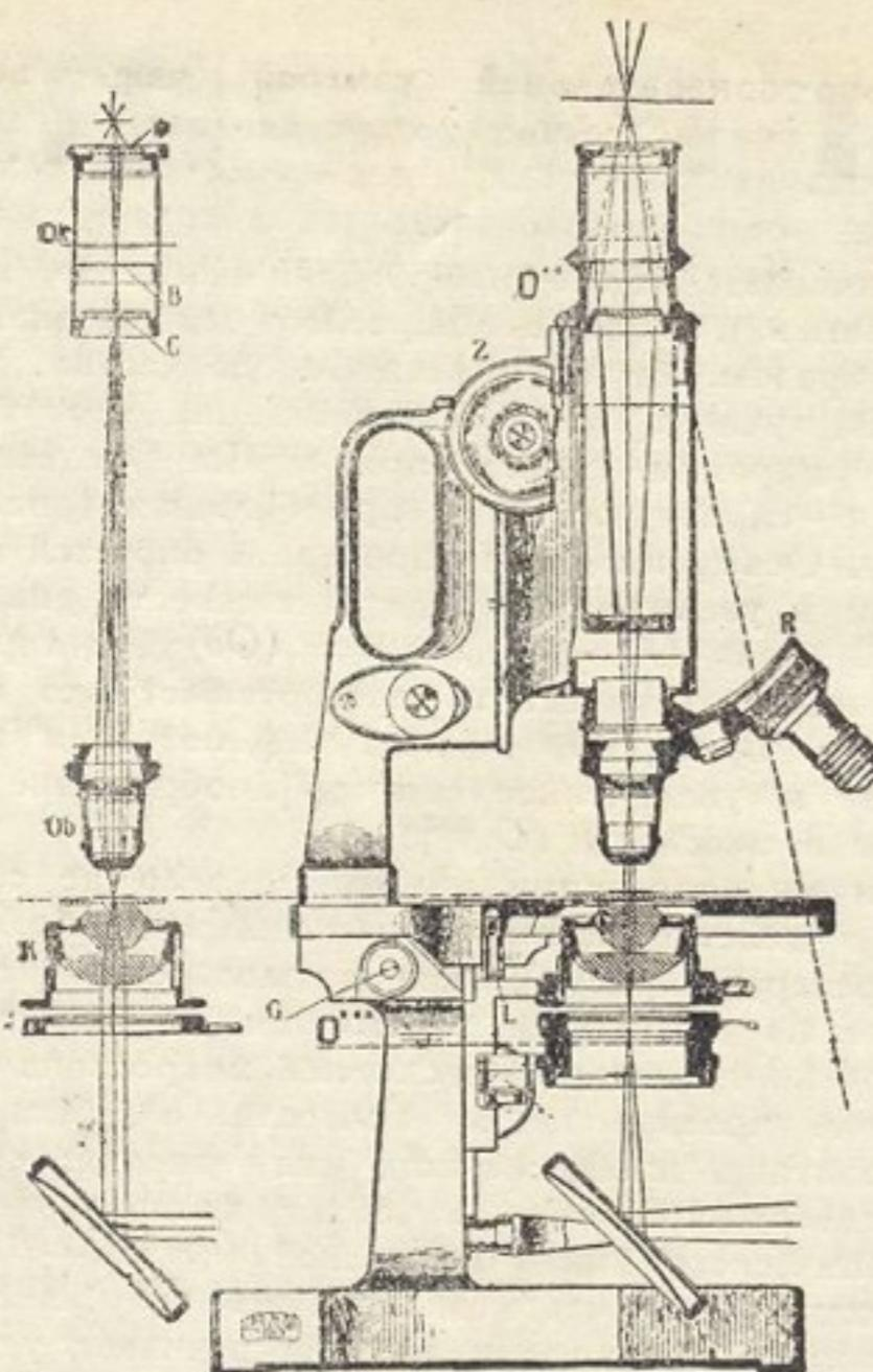
Рис. 1. Схема микроскопа
