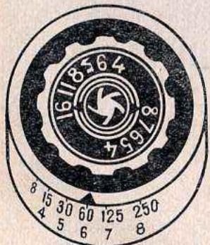
Рис. 28. Определение выдержки по экспозиционному числу.
