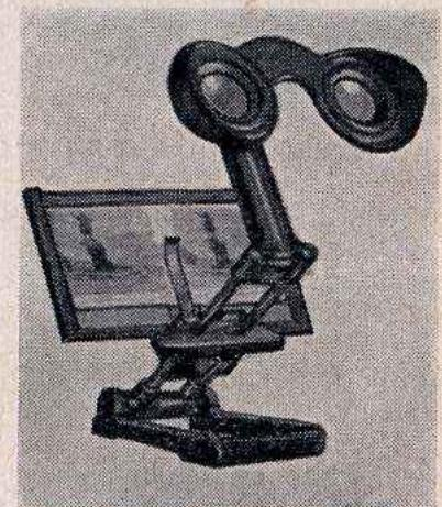
Рис. 20. Стереоскоп.
