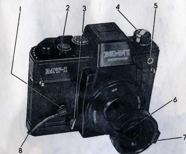
1 - штепсельный разъем для подключения впечатывающего устройства; 2 - втулка установки длительной выдержки "Д"; 3 - кнопка ручного впечатывания информации в кадр; 4 - головка обратной перемотки пленки; 5 - штепсельный разъем для подключения импульсных источников света; 6 - объектив "Мир-25МТ"; 7 - устройство для крепления эндоскопа; 8 - синхропровод для подключения впечатывающего устройства.
