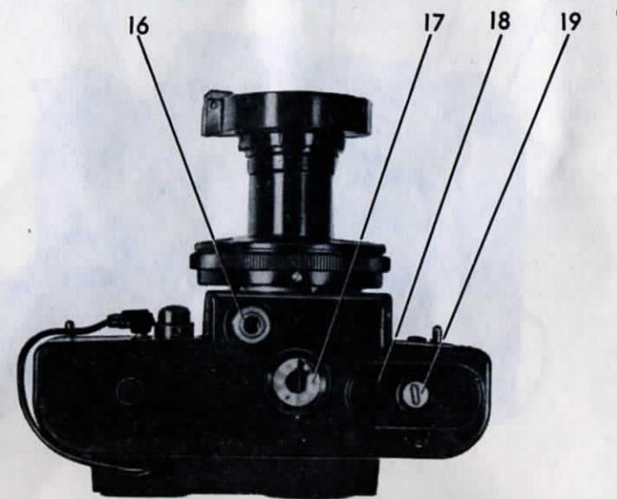
16 - штативная гайка; 17 - памятка типа пленки; 18 - крышка отсека элементов питания фотозавода; 19 - винт крепления крышки отсека питания.
