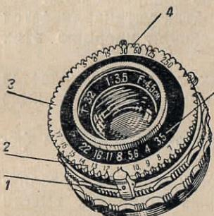
Рис. 17. Экспозиционная шкала фотоаппарата „Юность“
