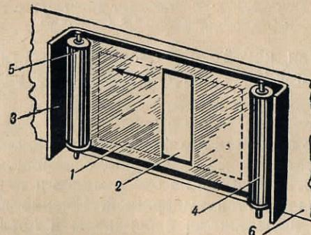
Рис. 8. Схема действия шторного затвора
