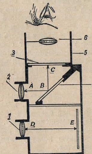
Рис. 22. Схема двухобъективного зеркального фотоаппарата
