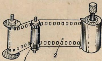
Рис. 13. Схема механизма передвижения пленки в малоформатных фотоаппаратах
