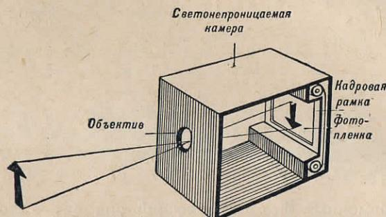
Рис. 1. Принципиальная схема устройства фотографического аппарата
