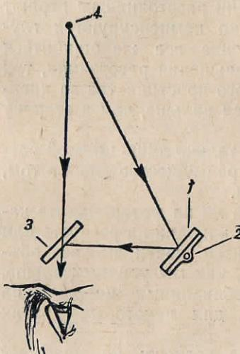
Рис. 11. Схема действия монокулярного оптического дальномера
