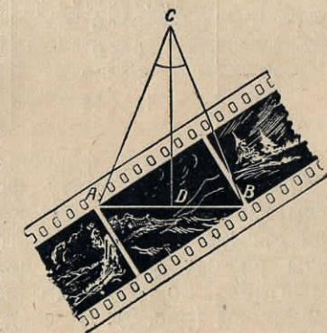
Рис. 4. Таким способом можно определить угол изображения объектива
