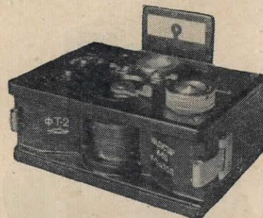
Рис. 54. Панорамный фотоаппарат „ФТ-2“
