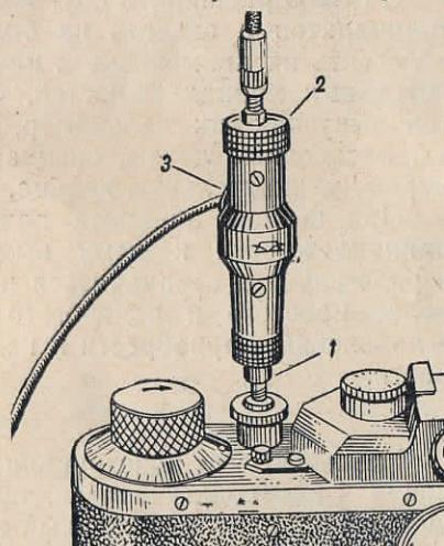
Рис. 70. Съемный синхронизатор
