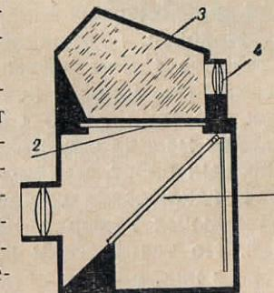
Рис. 24. Схема однообъективного зеркального фотоаппарата с оборачивающей оптической системой
