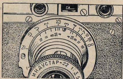
Рис. 19. Шкала глубины резкости на объективе „Индустар-22“
