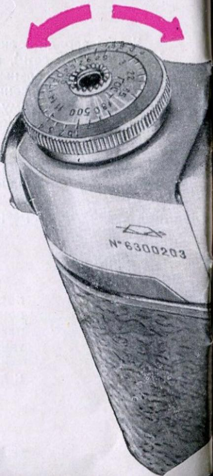
После совмещения стрелок автоматически будет установлена необходимая экспозиция для данной освещенности и чувствительности пленки. Чтобы проверить, при какой выдержке и каком относительном отверстии диафрагмы происходит съемка, следует посмотреть, после того как стрелки совмещены, какие цифры стоят против черного индекса на кольце выдержек и кольце диафрагмы.
