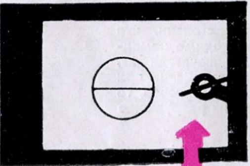
Затем, наводя аппарат на снимаемый объект и глядя в окуляр, поворотом головки установки экспозиции вправо или влево совместить видимые в поле зрения стрелки экспонометра.
