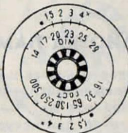
Прибор не позволяет учитывать светофильтр с кратностью более 1,5 $\times$  при чувствительности 22 ед. ГОСТ, более 2 $\times$  — при чувствительности 32. При чувствительности 16 кратность светофильтра не учитывается. Эта особенность распространяется соответственно и на шкалу чувствительности, в градусах DIN.
