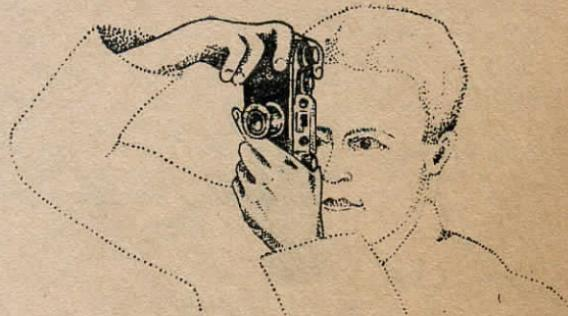
Рис. 13. Правильное положение аппарата при съёмке на вертикальный формат.
